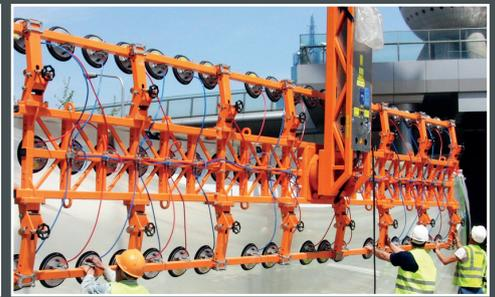
Der Markenname OKTOPUS® steht als Synonym für Vakuumhebergeräte zur Montage oder zum Handling von Gläsern und Fenstern oder großformatiger Dach-, Wand-, Decken- und Fassadenelemente aus Sandwich- und Trapezblechprofilen.
